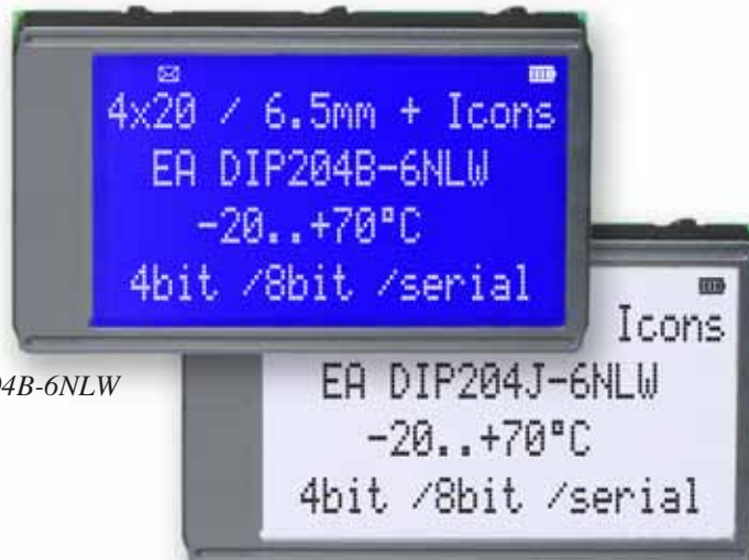
EA DIP204J-6NLW: Abmessungen 75 x 46 mm
