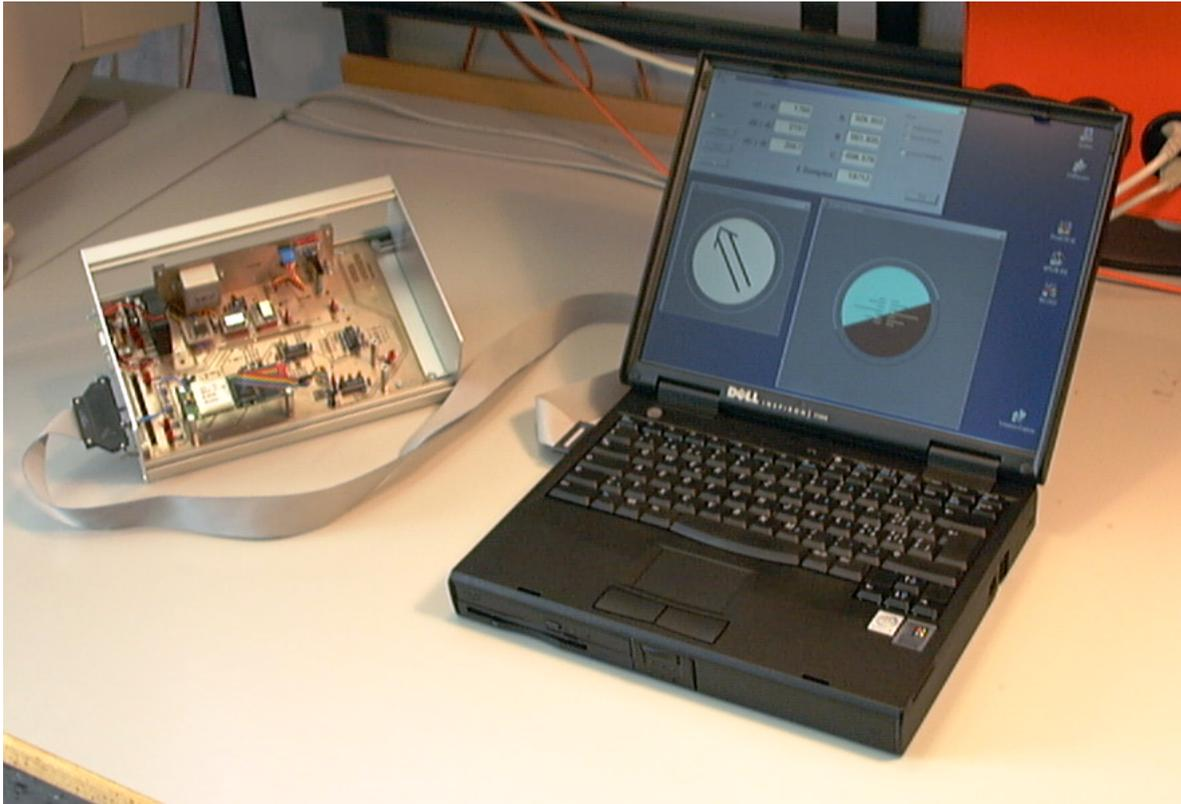
Abbildung 10: Das fertige System mit Laptop, Sensor Board und PCMCIA-Messkarte
